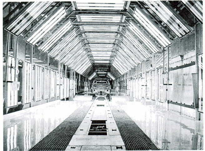
Die ESD-Bodenbeschichtung Rompox 1107 wird beispielsweise in Automobilwerken wie hier in China eingebaut. Foto: Romex
